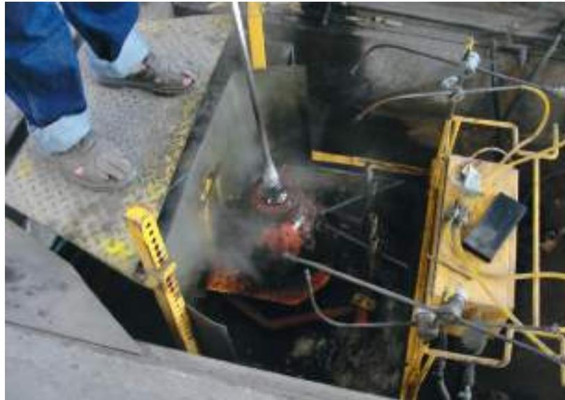
*Figura 22. Mecanización del proceso de enfriamiento de moldes.*
