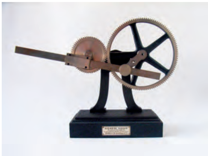
Modelo de cadeia de rodas planetárias com barra corredeira segundo Reuleaux Fabricante: Gustav Voigt, Berlim Museu de Ciência da Universidade de Lisboa Inv. 3622 Foto MCUL/V. Teixeira
