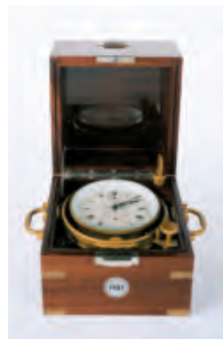
Relógio Nardin, utilizado para medição do tempo sideral, e respectivo estojo para transporte Metal, vidro e madeira Dim: 19 x 21 x 19 cm Instituto de Investigação Científica Tropical Inv. 1064 Foto: IMC/Lúisa Oliveira
