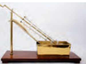
Parafuso de Arquimedes (também designado de bomba de parafuso) Instrumento didáctico para observação, através do tubo de vidro helicoidal, da transferência de um líquido entre dois pontos com diferente elevação Fabricante desconhecido Latão, vidro e madeira Dim.: 41 x 55,7 x 19,5 cm ISEP: Inv. MPL120BJ Foto: ISEP/Oscar Andrade
