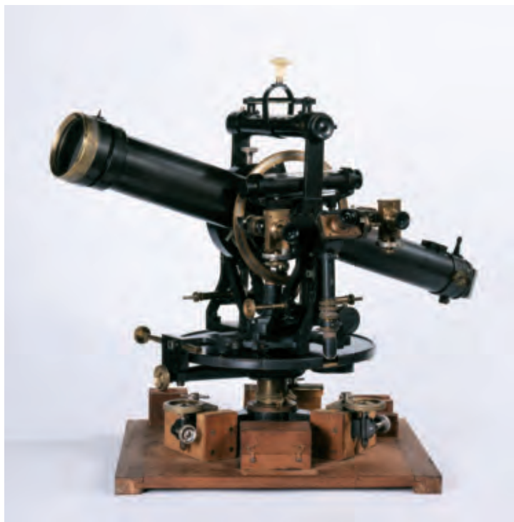
Teodolito Modelo: Salmoiraghi n.º 3. N.º de série: 21602 Para triangulação e astronomia Sob proposta de Gago Coutinho foram adquiridos quatro teodolitos deste modelo em 1909 pelo Ministério das Colónias, para os trabalhos da Missão Geodésica da África Oriental. Gago Coutinho, que pretendia instrumentos especialmente adaptados às missões em África, refere em 1911: “com condições especiais que não se encontram em catálogo algum pois eram modificações dos círculos geodésicos empregados nos Estados Unidos e na Europa, e um meio termo para os Universais de Repsold usados em Portugal e na África do Sul” Metal, vidro e madeira Dim: 66,5 x 34 x 33 cm Instituto de Investigação Científica Tropical Foto: IMC/Lúisa Oliveira
