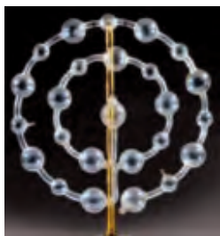
Instrumento para observação de descargas eléctricas em atmosfera gasosa. Vidro e Latão Dim: 46,3 x 9,5 x 39,5 cm Museu de Ciência da Universidade de Coimbra Inv. MFUC 523 Foto: IMC / José Pessoa.
