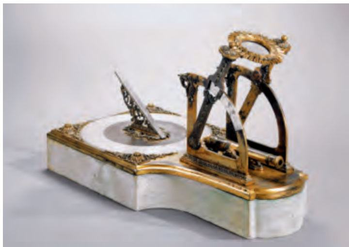
Relógio de Sol Portugal, Século XIX Relógio de sol horizontal, com meridiana e alidade em bronze, lente de cristal e mostrador e gnómon em platina. O conjunto, incluindo uma miniatura de canhão entre os limbos da alidade, é encastrado em base de bronze, por seu turno assente sobre base em mármore. Decorado com motivos vegetalistas e com inscrições relativas aos meses, dias e horas, bem como aos solstícios e aos símbolos do zodíaco Oferecido a D. Fernando II pelo Barão de Kessler, cientista de renome que chegou a Portugal em 1836 como seu médico de câmara Dim: 34 x 61 x 34,5 cm Palácio Nacional da Pena Inv. 2108 Foto: IMC/José Pessoa
