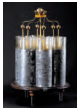
Bateria eléctrica, composta por sete garrafas de Leiden Século XIX Vidro, folha de estanho, latão e madeira Dim: 78 x 45 cm Museu de Ciência da Universidade de Coimbra Inv. FIS.0245 Foto: IMC/José Pessoa
