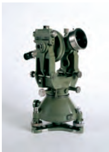
Teodolito Modelo: WILD T3 N.º de série: 29895 Para triangulação e azimute astronómico O teodolito Wild T3, concebido por Heinrich Wild em 1925, foi um dos instrumentos geodésicos mais utilizados em todo o mundo. Este teodolito foi utilizado pela Comissão de Cartografia (organismo antecessor do IICT) na Missão Geográfica de Cabo Verde (1926-1931) e na Missão Geográfica de Moçambique (1932-1983) Sobre este instrumento refere o comandante Baeta Neves (1930): «Explêndida luneta. O aparelho é cómodo, próprio para regiões montanhosas com pontos de difícil acesso; no entanto a caixa de metal que envolve o aparelho não me parece a mais apropriada para o transporte nas montanhas e por maus caminhos. As caixas de madeira são a meu ver melhores. Os aparelhos assim ligados às respectivas caixas metálicas sofrem todo e qualquer choque que a caixa dê; a caixa de madeira acondiciona melhor o instrumento protegendo-o melhor de qualquer choque» Metal e vidro Dim: 37 x 27 x 20 cm Instituto de Investigação Científica Tropical Foto: IMC/Luís Oliveira
