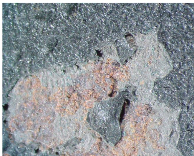
**Figura 44:** *San Antonio Abad*. En esta fotografía con lupa binocular se observa la rugosidad de la capa pictórica, además de la corrosión surgiendo desde la lámina metálica.
