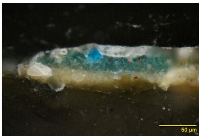
Figuras 31 y 32: Cortes estratigráficos. *Los discípulos de Emaús* (izq.) y *Las siete obras de la misericordia* (der.). En ambas fotografías es posible observar una coloración verde en el borde inferior del primer estrato que probablemente corresponde a oleato de cobre.
