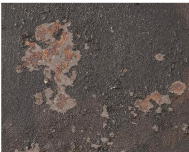
**Figura 43:** *San Antonio Abad*. Detalle de corrosión activa y formación de ampollas que emergen desde el soporte a la superficie.
