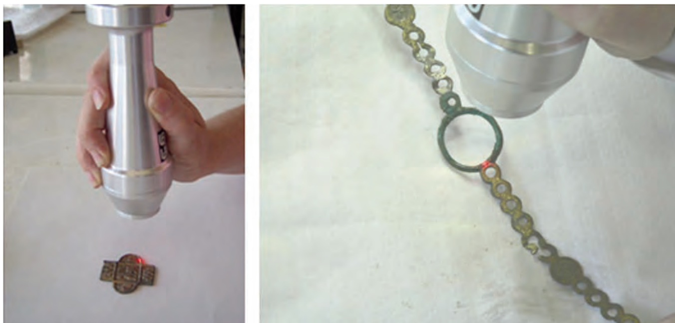
Figura 10. Imágenes del proceso de limpieza láser de dos piezas doradas realizadas en la época musulmana mediante la técnica de dorado al fuego. Cortesía del laboratorio de restauración de la Universidad Autónoma de Madrid.
