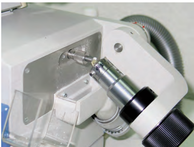
Fig. 8. Proceso de tallado de la muestra para que el plano de corte tenga sección trapezoidal: a) detalle del trabajo con fresadora; b) resultado final.
