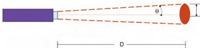
Figura 4. Divergencia de un láser
