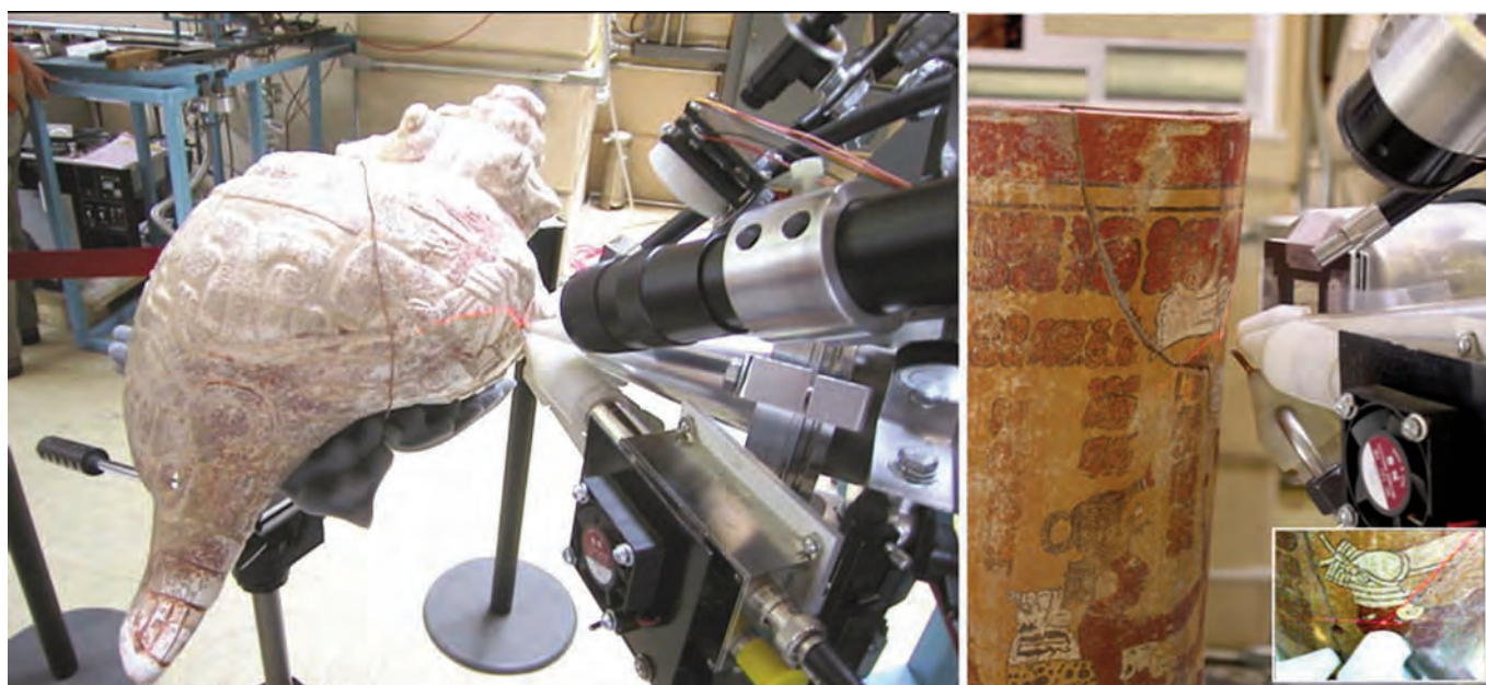
Figura 15. Irradiación de la superficie pigmentada de un caracol prehispánico grabado y de un vaso Maya con la milisonda del sistema de haz externo del acelerador Peletrón del IFUNAM.
