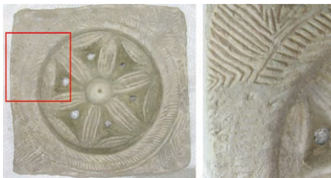
Figura 9. Imagen de la limpieza con láser de los contaminantes superficiales encontrados en un sumidero de la época tardo-romana. En la imagen de la izquierda se observa una imagen general de la pieza antes de comenzar la limpieza, mientras que en la derecha se muestra un estado intermedio de la limpieza de la zona señalada en la imagen anterior, en la que se comprueba la revelación de los relieves ocultos por los depósitos. Fotos cortesía de ARTEMON, S.A.
