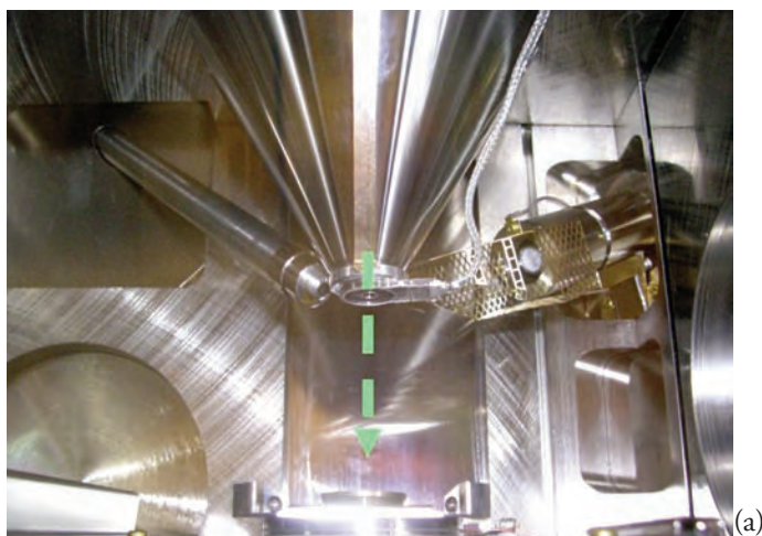
Figura 2. (a) Interior de la cámara de vacío del microscopio electrónico. La flecha indica por donde incide el haz de electrones (b) Soporte donde se colocan las muestras. En este caso las muestras están recubiertas por una película de oro.
