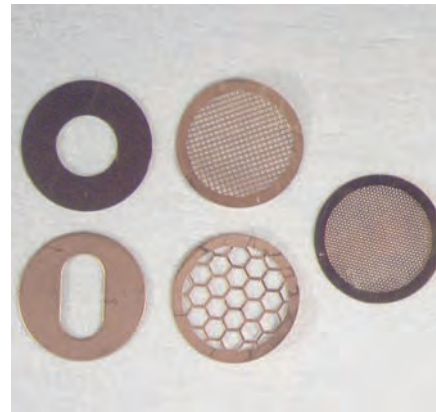
Fig. 9. a) Obtención del corte ultrafino y recogida en el baño; b) Corte recogido en la rejilla; c) Diferentes tipos de rejillas.
