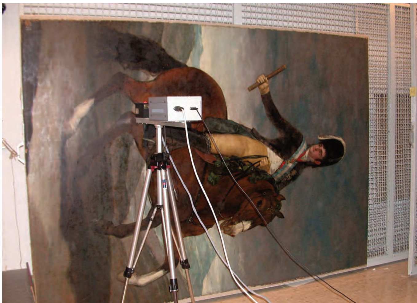
Fig. 2. Estudio mediante fluorescencia de rayos X sin toma de muestra. Fernando VII , Francisco de Goya, Real Academia de Bellas Artes de San Fernando. Estudio realizado por D. Juanes C. Martín, M del Egido (IPHE).
