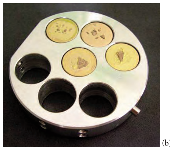
Figura 2. (a) Interior de la cámara de vacío del microscopio electrónico. La flecha indica por donde incide el haz de electrones (b) Soporte donde se colocan las muestras. En este caso las muestras están recubiertas por una película de oro.
