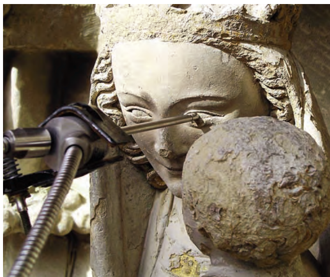
Figura 1. Estudio realizado en la portada de la Catedral de Huesca con un espectroscopio de infrarrojos acoplado a una sonda de fibra óptica.
