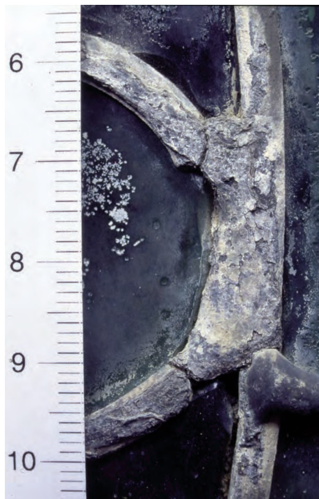
Imagen 11. Monasterio de Haina (Alemania). Fragmento de una vidriera con plomos del siglo XIII soldados con estaño, seriamente afectados por oxidación y corrosión además de presentar fracturas puntuales en las zonas de unión entre ambos metales.
