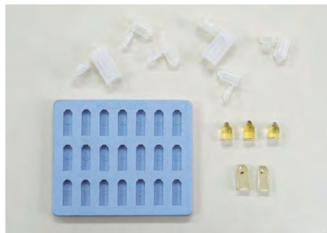
Fig. 6. Diferentes moldes y recipientes utilizados en la preparación de muestras y ejemplos de varias muestras incluidas
