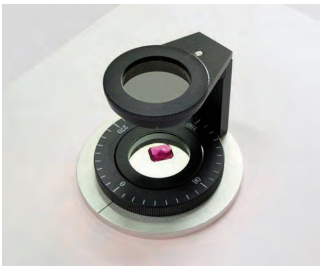
Figura 4. Polariscopio; a) utilización con dos polarizadores; b) utilización con un solo polarizador.
