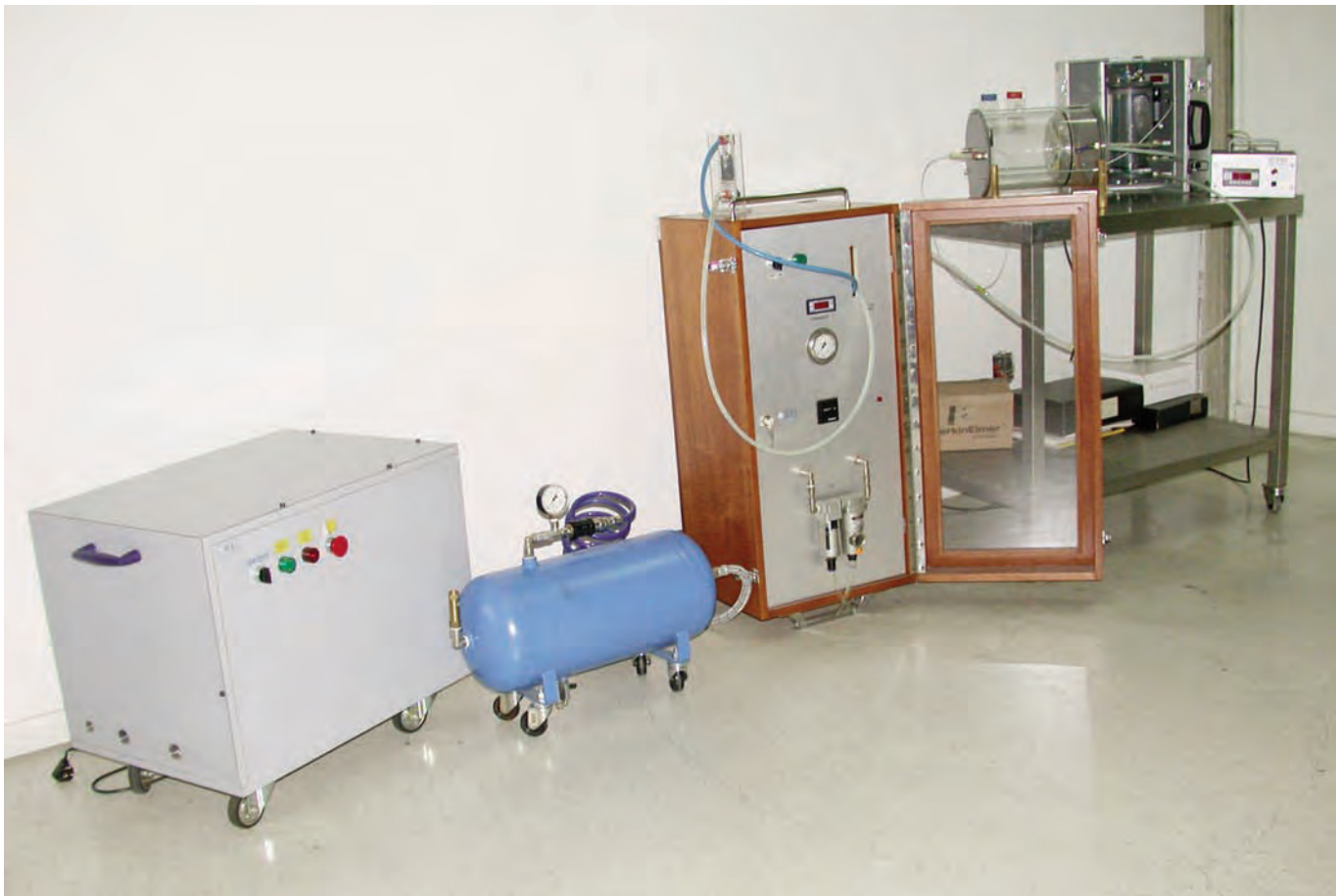
Sistema de desinsectación por gases inertes
