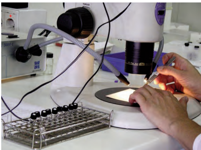
Figura 5. Selección de microfragmentos a partir de una muestra para ser procesados en cromatografía de gases.
