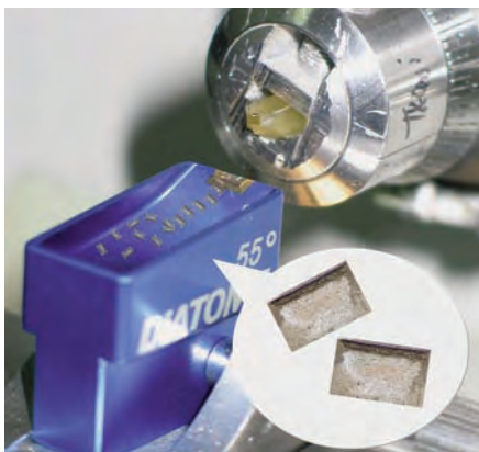
Fig. 9. a) Obtención del corte ultrafino y recogida en el baño; b) Corte recogido en la rejilla; c) Diferentes tipos de rejillas.
