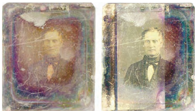
Figura 12. Imágenes correspondientes a la limpieza con láser de un daguerrotipo. En la foto de la izquierda se muestra la pieza antes de la limpieza, y en la foto de la derecha se muestra la misma pieza tras la limpieza (parcial) con láser. Fotos tomadas de [15]
