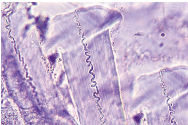
Figura 14. Ensayo microquímico con el reactivo de Schweitzer (a) Imagen de un canal de lino tras disolver la pared celular. (b) Imagen de un canal de cáñamo tras disolver la pared celular
