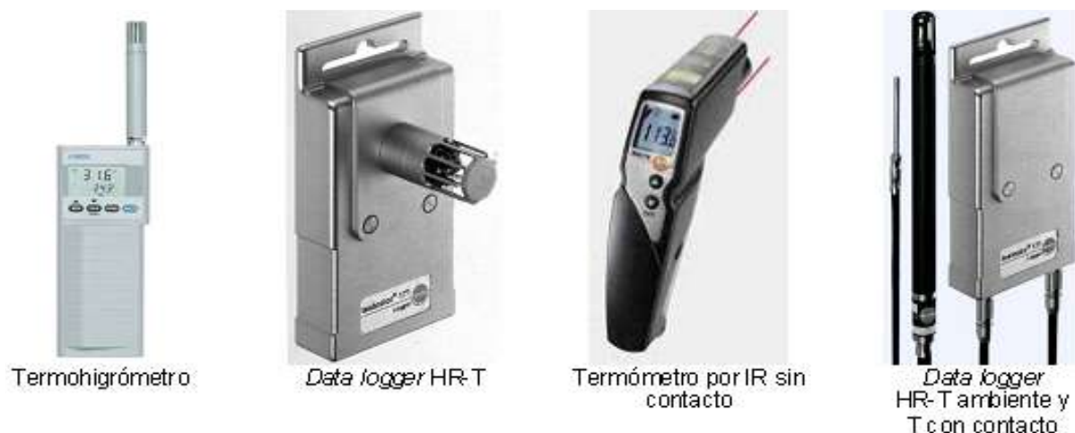
Figura 1. Instrumentos de diagnóstico. Vaisala y Testo.
