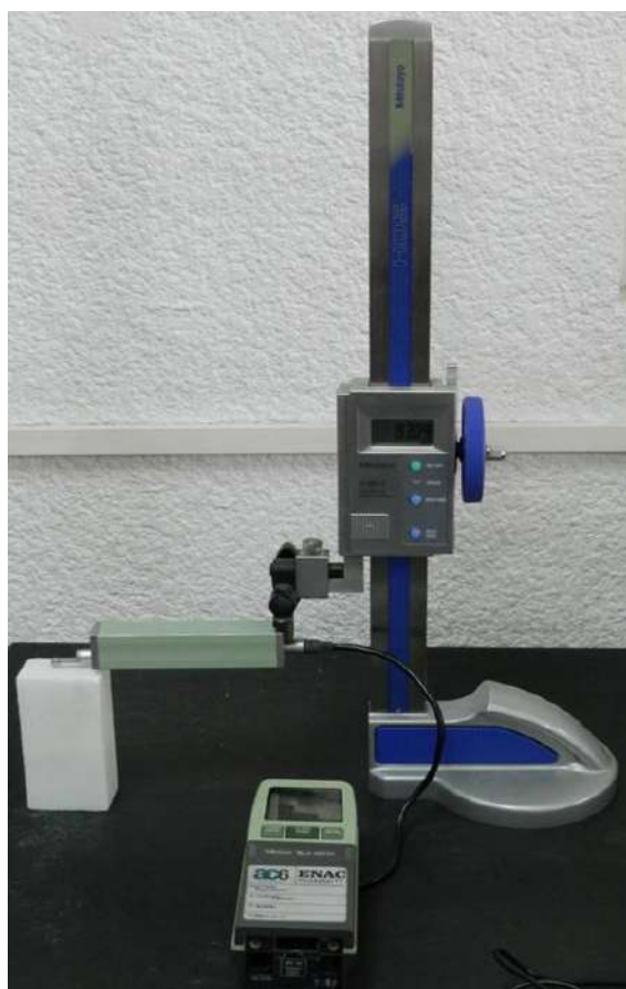
Figura 2. Perfilómetro (verde) midiendo una probeta de mármol. El equipo auxiliar (azul) se utiliza de sujeción y nivelación.
