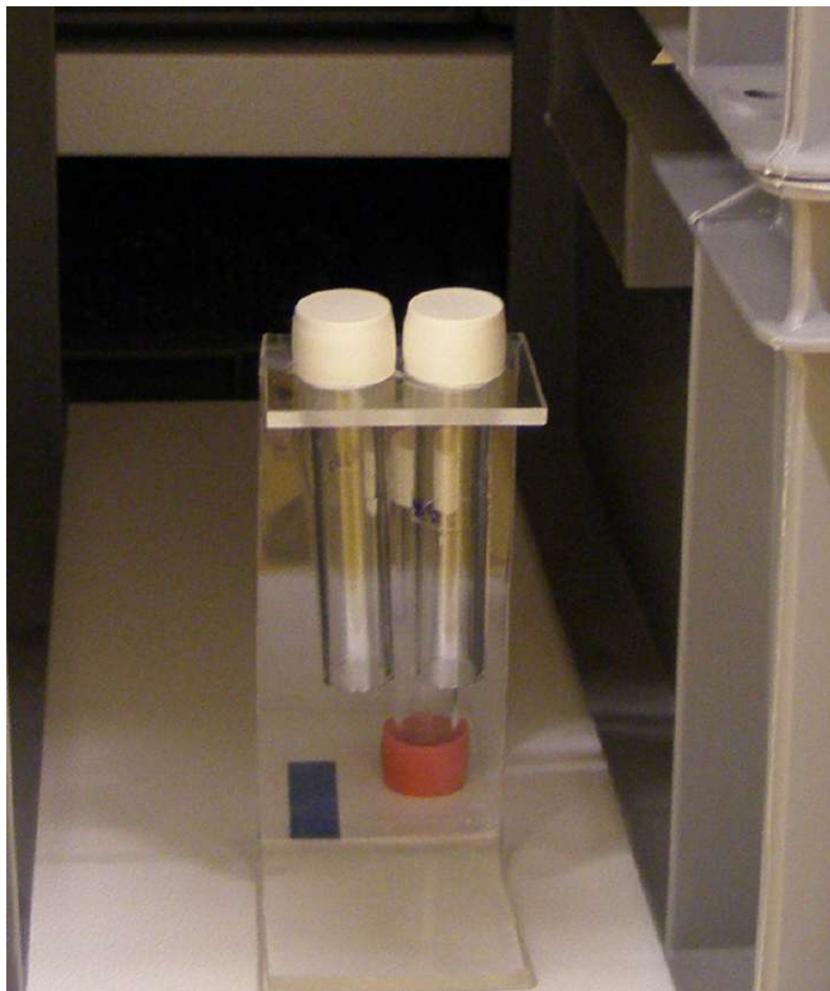
Figura 1. Exposición de los tubos de Palmes y Danchek® en almacén de museo. Fotografía: Diana Lafuente.
