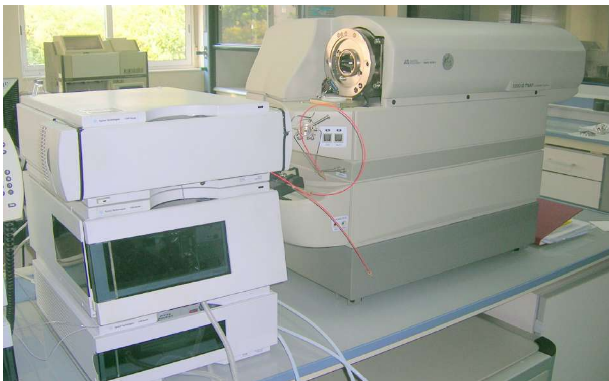
Figura 7. Equipo utilizado: Agilen 1200 con detector 3200 QTrap.
