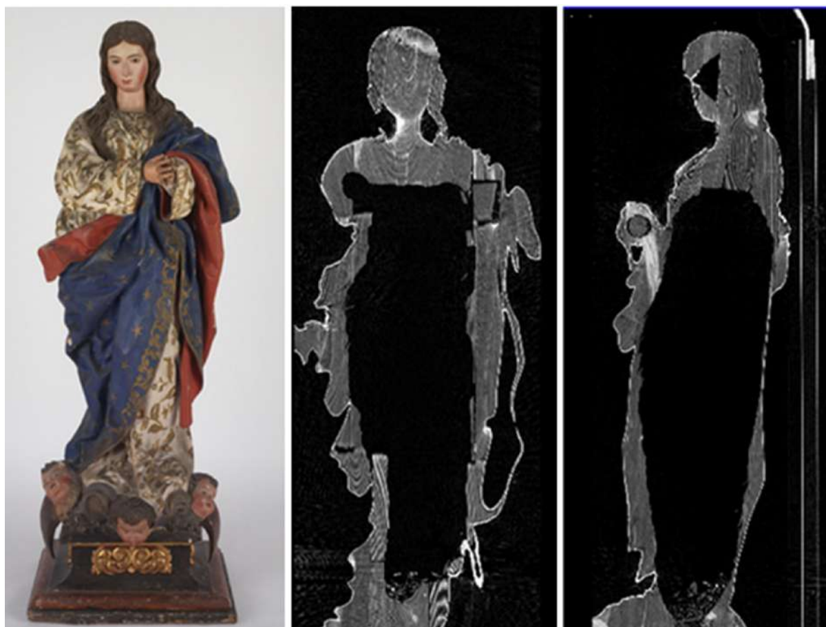
Figura 9. Imagen de la escultura previa a su intervención e imágenes de los cortes coronal y sagital de la pieza obtenidos mediante TAC médico.
