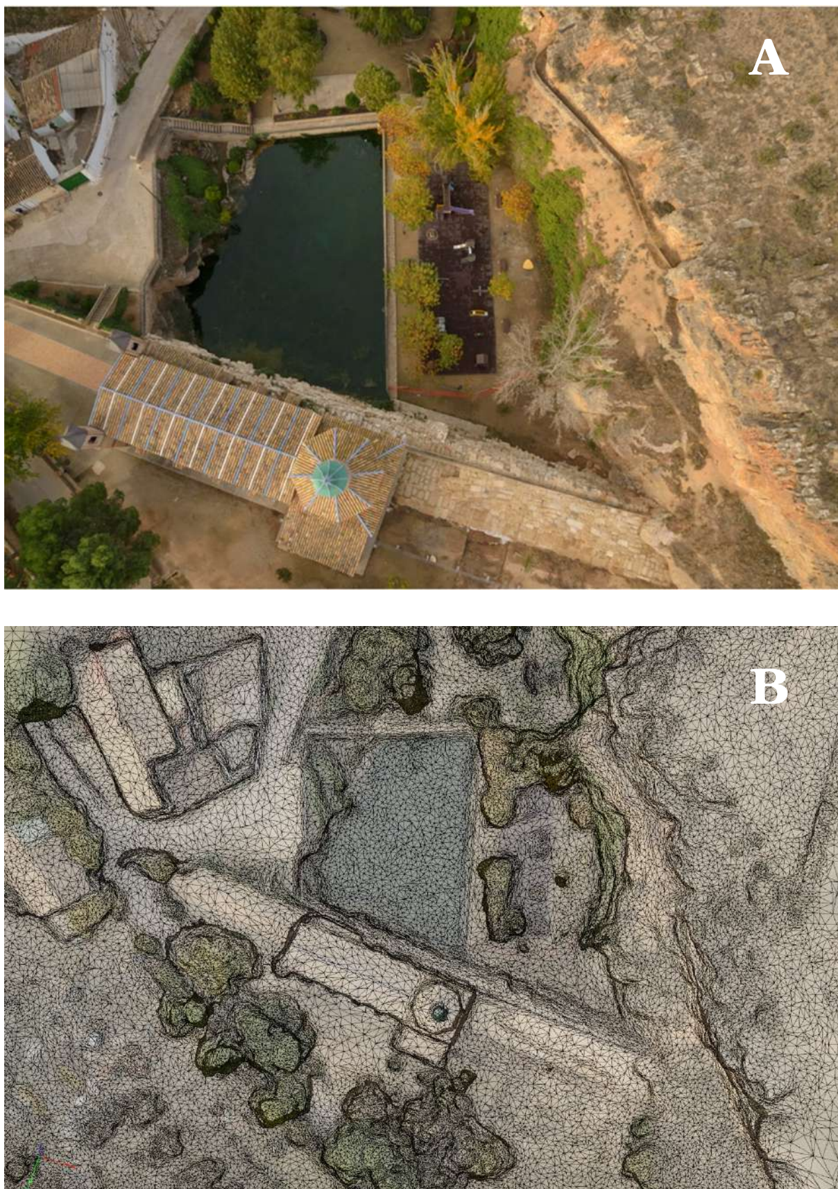
Figura 4. A) presa romana de Muel (Zaragoza) registrada a 85 metros de altura con un UAV; B) modelo 3D triangulado y gestionado en diferentes capas en un fichero estándar pdf 3D.
