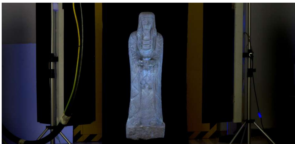
Figura 3. Estudio de imagen con fluorescencia ultravioleta de una escultura.
