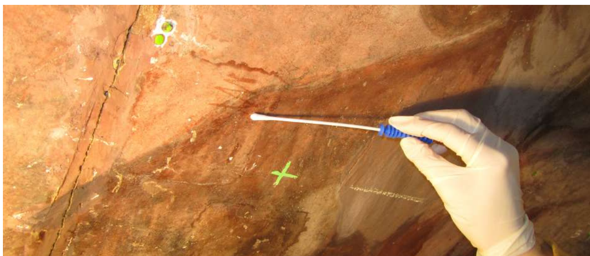
Figura 4. Proceso de control microbiológico, mediante técnicas bioquímicas de medición del contenido de ATP utilizando bioluminiscencia.
