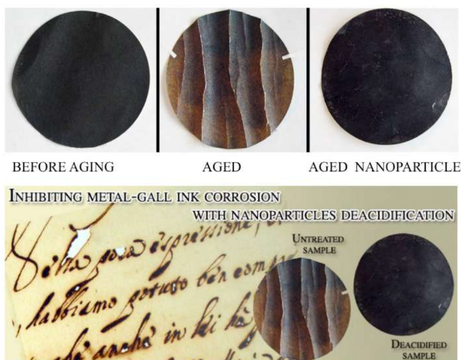
Figura 2. Capacidad inhibidora de la desacidificación con nanopartículas ante la corrosión de las tintas metalogáficas. Fuente: Langmuir, n.º 26 (24).
