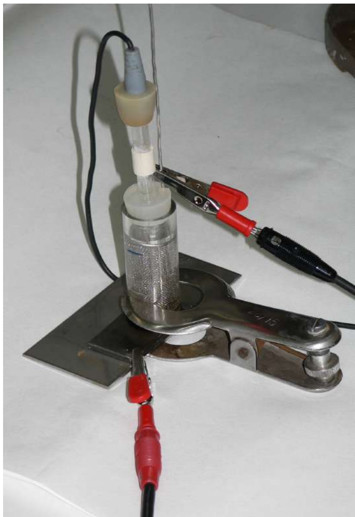
Figura 2. Ensayo electroquímico de una probeta simulando hierros históricos para la evaluación de recubrimientos protectores frente a la corrosión.
