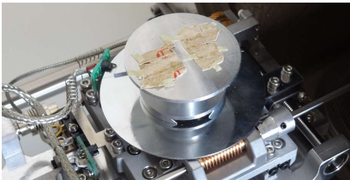
Figura 4. Imagen de los dos fragmentos de papel después del análisis mediante VP-SEM-EDX con un equipo Hitachi 3400 N.
