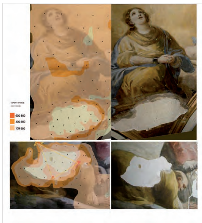
Figura 6. Cartografía de sales documentando “halos” salinos. Ejemplo de la bóveda “Regina Martirum” con frescos de Francisco de Goya en la Basílica del Pilar.
