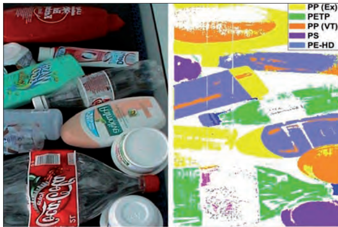
Fig. 12a. Sistema de reciclaje de plásticos basado en la aplicación de la técnica hiperespectral.
