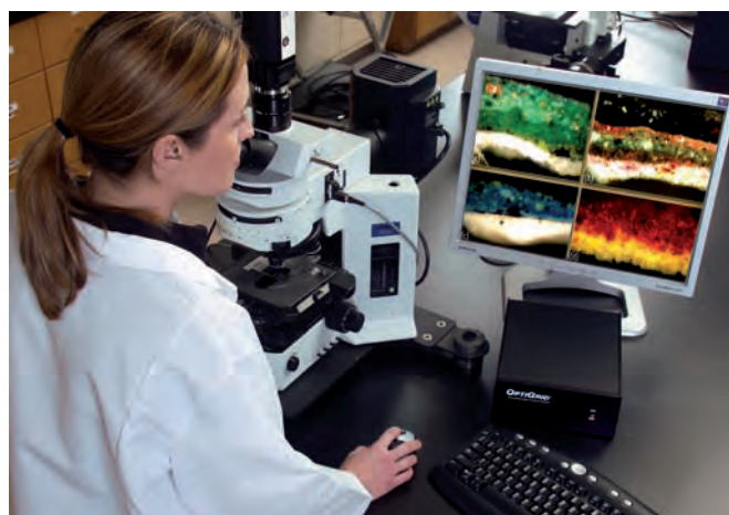
Fig. 15. Sistema hiperespectral sobre microscopio analizando composición de cortes transversales de pintura.
