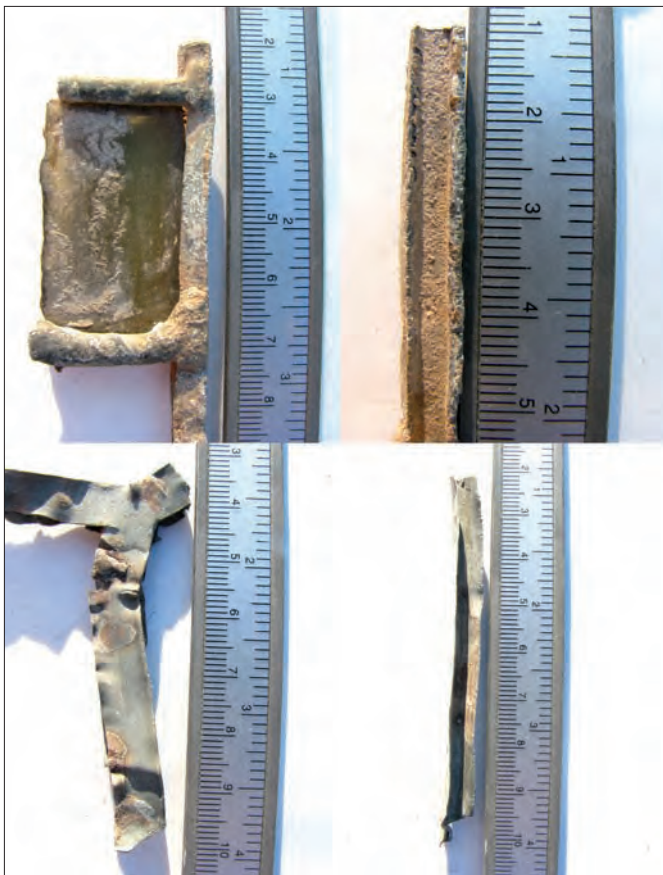
Fig. 5. Detalles de dos perfiles de plomo procedentes de diferentes vidrieras; arriba: Iglesia del Monasterio de Pedralbes (Barcelona) -siglo XIV-; abajo: Iglesia de Valpueda (Burgos) -probablemente de la segunda mitad del siglo XVI o la primera mitad del siglo XVII-. (Fotos: Fernando Cortés).
