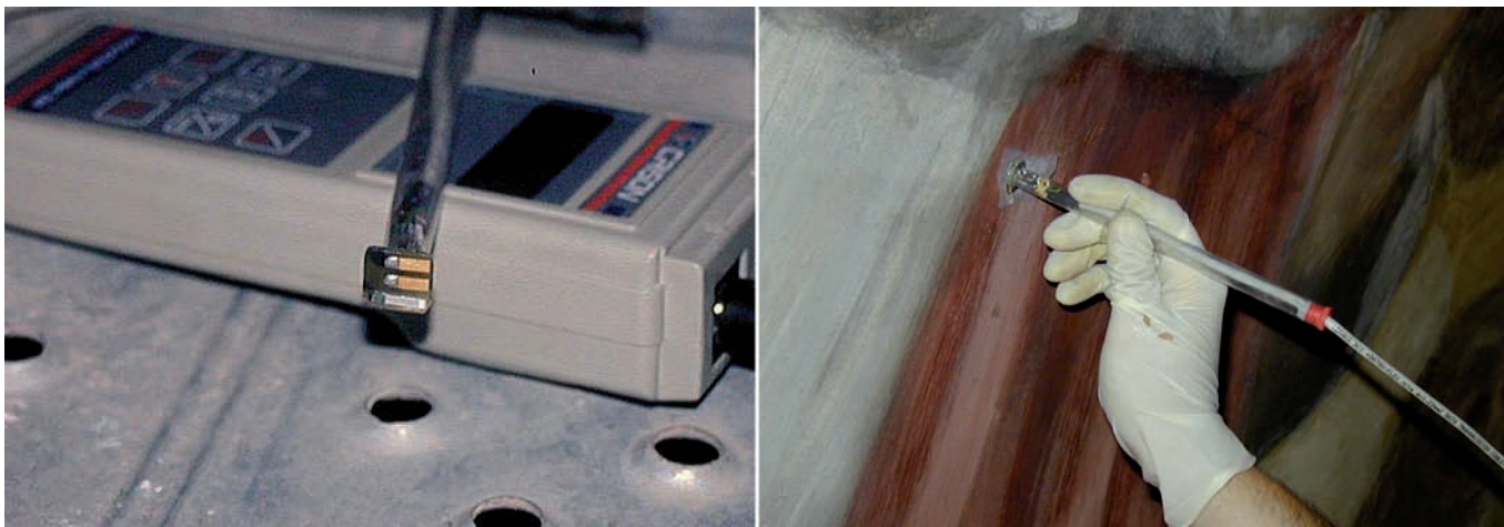
Figura 2. Sonda para conductímetro que permite medir la conductividad superficial. El equipo de medida es comercial. La sonda está fabricada sobre diseño del equipo Arbotante por el Servicio de Instrumentación Científica de la Universidad de Zaragoza.
