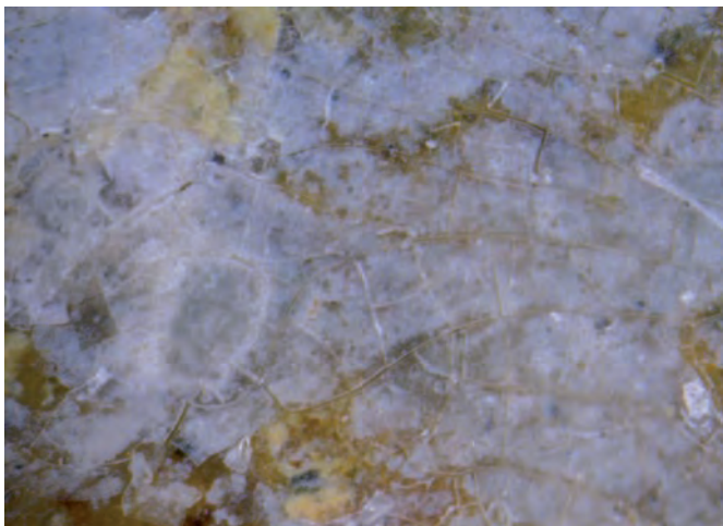
Figura 21. Imágenes de microscopio óptico portátil. Esta técnica permite evaluar la eficacia de la metodología de aplicación del consolidante.
