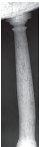
← Figura 8. Radiografía. Mobiliario. Estado de conservación: ataque de insectos xilófagos.
