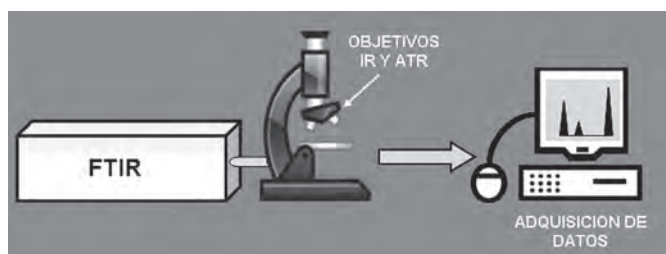
Figura 3. Esquema de un microscopio acoplado a un espectrómetro de infrarrojos.
