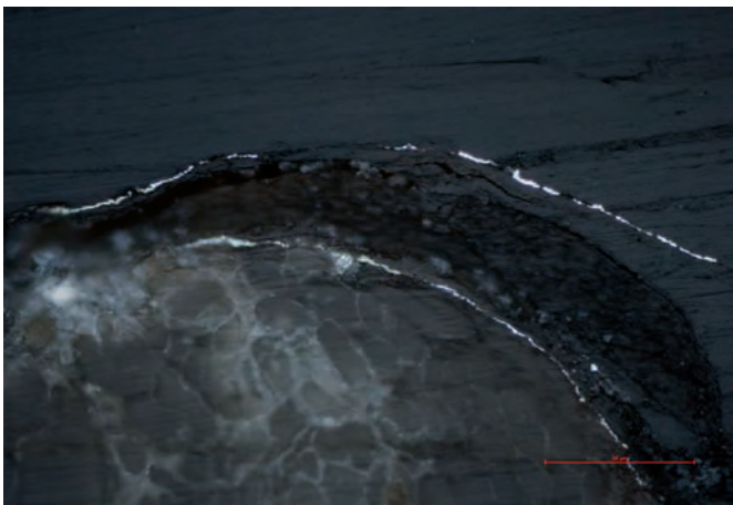
Figura 7. La muestra del oro de Chipre observada en sección estratigráfica donde se aprecia la lámina de plata unida al substrato orgánico.
