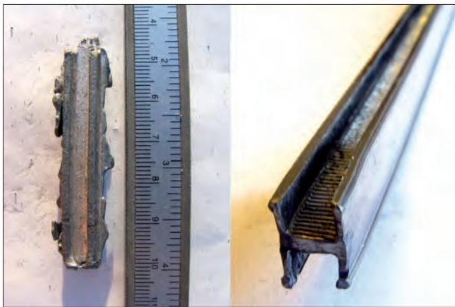
Fig. 3. Izquierda: fragmento de un perfil de plomo actual en bruto después de salir del molde y antes de su desbastado y estirado; derecha: perfil de plomo actual listo para ser usado. (Fotos: Fernando Cortés).
