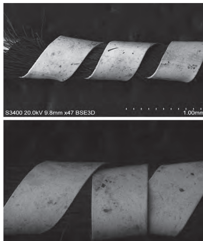
Figura 12. Imágenes SEM en modalidad BSE de los entorchados en plata dorada.
