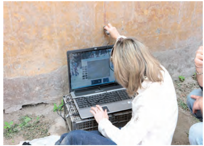
Figura 14. Técnico del IVC+R durante la observación de la superficie policromada con microscopio óptico portátil.
