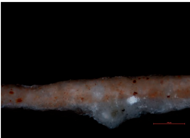
Figura 13. Imagen en microscopía óptica y mapa RX de la sección estratigráfica de una muestra de pintura mural. En el mapa se aprecia la distribución del calcio y del azufre. Este último elemento debido a la presencia de sales.
