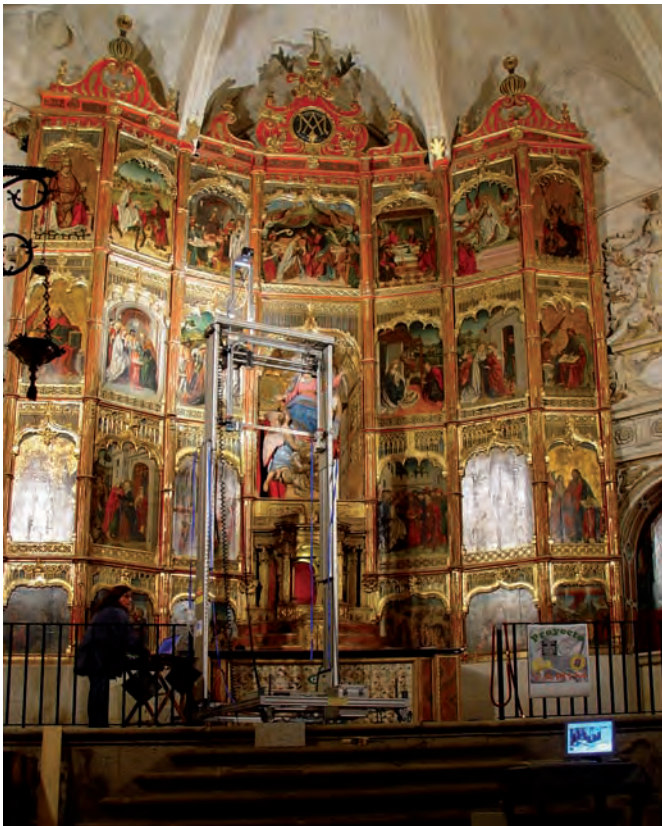
Figura 4. Prototipo mecanizado desarrollado por el IPCE en colaboración con la Escuela Técnica Superior de Ingenieros de Telecomunicación en el proyecto de investigación VARIM para la realización de reflectografía y radiografía in situ en grandes formatos. Imagen de Tomás Antelo.
