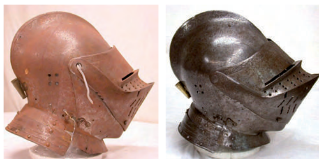
Figuras 4a y 4b. Celada antes (izquierda) y después (derecha) del tratamiento de restauración. Foto: Museo del Ejército.
